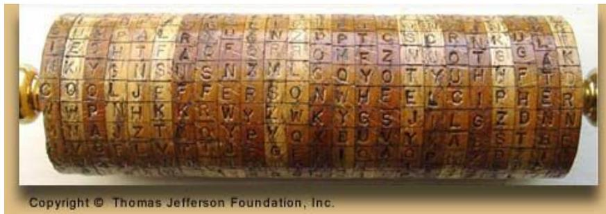
Der Sender übertrug nun eine beliebige andere Zeile (z.B. die direkt darunter) an den Empfänger, der diese erneut auf seine Maschine anwendete und nun in den anderen 25 Zeilen nach der suchte, die Sinn ergab.
