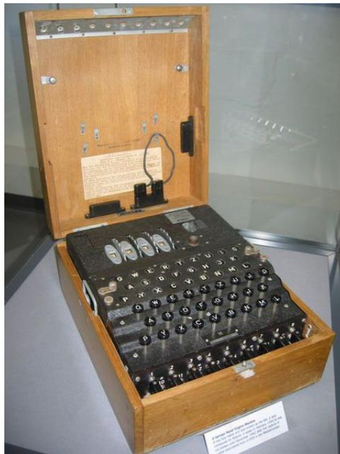
Der Verschlüsselungsmechanismus besteht aus einem Rotorensystem. Die einzelnen Rotoren haben seitlich Schleifkontakte angebracht und leiten den Strom der Tastatur von der einen Seite zu einem anderen Kontakt auf der anderen Seite.
