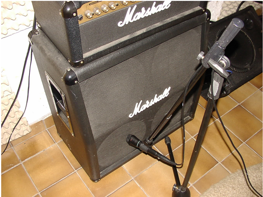
Abbildung 27: Positionierung des Mikrofons vor dem Verstärker
